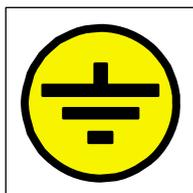
Выполните заземление фильтрующего оборудования согласно нормам вашей страны. Гибким медным проводом сечением  $10 \text{ мм}^2$  подключите фильтрующее оборудование и техническую часть к заземлению.
